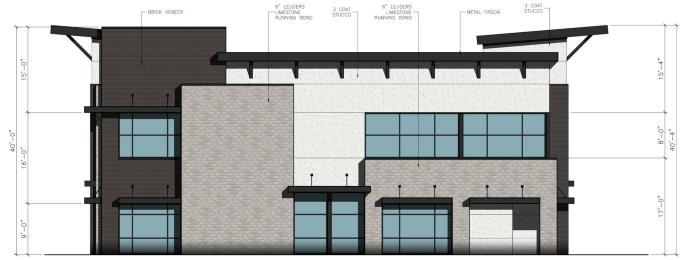
1 - SIDE ELEVATION (EAST) SCALE 3/16"=1'-0"
